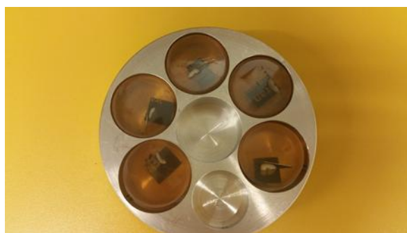
Слика 6.12. Алуминијумски носач за посматрање узорака под СЕМ-ом
